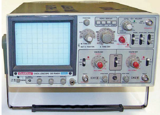
شكل (37): جهاز رسم الإشارة Oscilloscope
