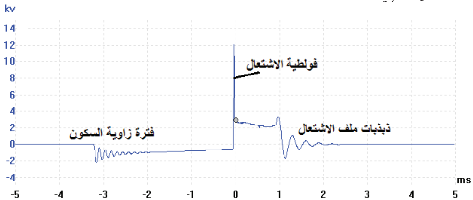
شكل (53): إشارة الدائرة الثانوية لنظام الاشتعال التقليدي
