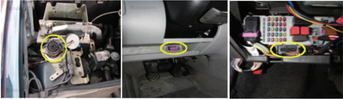
شكل (8) : أمثلة على مواقع وصلة التشخيص في مركبات مختلفة
