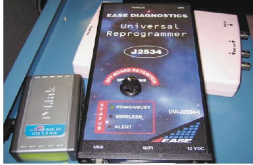
شكل (66) : جهاز برمجة يدعم نظام SAE J2534
