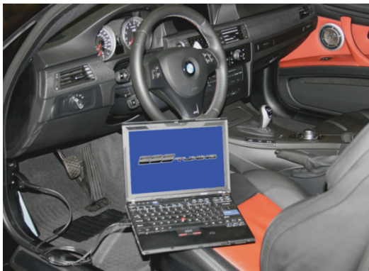
شكل (63): البرمجة المباشرة لوحدة التحكم
