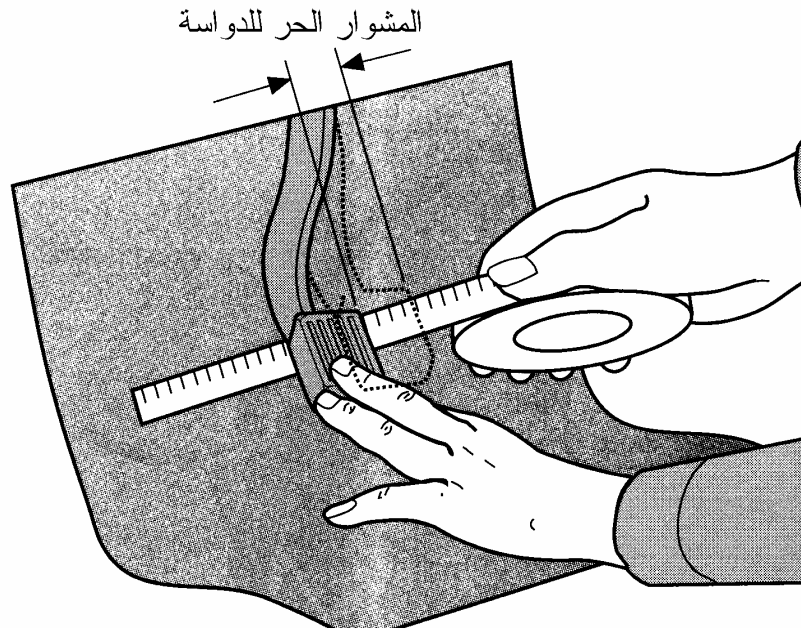
شكل رقم ( ١ ) يوضح كيفية قياس المشوار الحر لدواسة القابض
